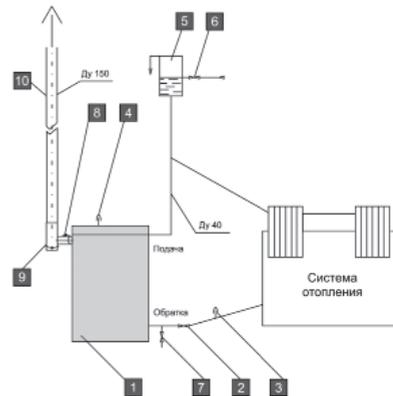
б) Открытая система с самоточной циркуляцией
