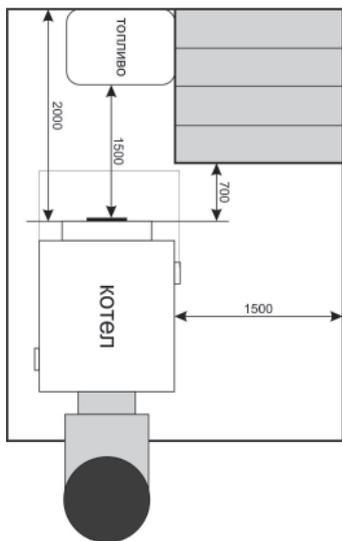
**Установка котла, монтаж дымовой трубы и системы отопления должны производиться в соответствии с «Правилами устройства и безопасной эксплуатации паровых котлов с давлением пара не более 0,07 МПа (0,7кг/см<sup>2</sup>), водогрейных котлов и водонагревателей с температурой нагрева воды не выше 338 К (115°С)».**
